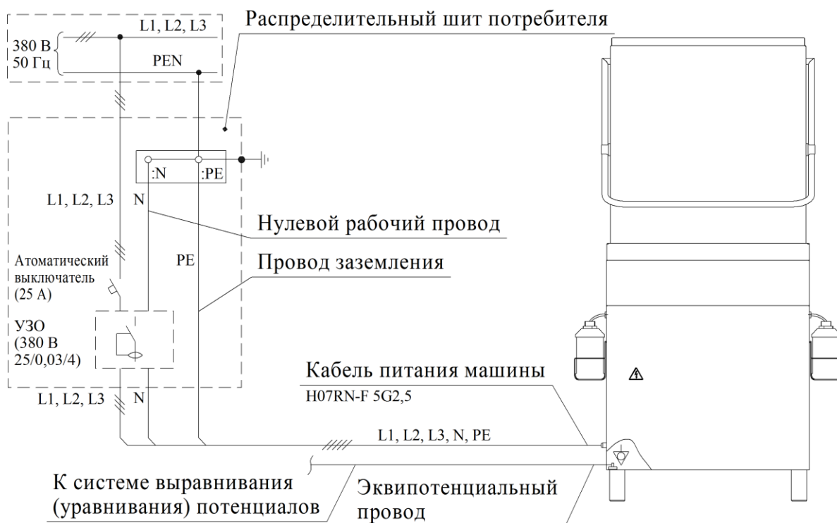
Рисунок 7 – Схема электрическая подключения машины к электрической сети
