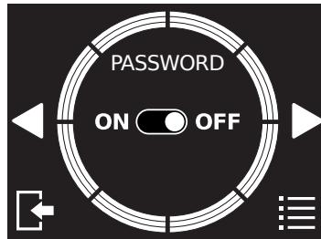
Pour choisir le mot de passe, il est nécessaire créer un code à 4 chiffres. Après avoir appuyé sur **CONFIRMER**, il est nécessaire de la répéter et appuyer sur **CONFIRMER**.
