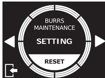
Durch Drücken der **EINSTELLUNG** Taste zugreifen Sie in das Menü zur Aktivierung/Deaktivierung des Mahlscheibenwartung-Warnsystems und der Einstellung von Mahlwerksgröße und -typ.
