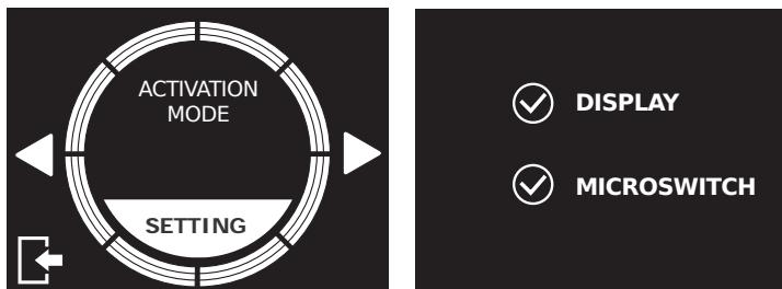
Nach dem Drücken der Taste **EINSTELLEN** können Sie wählen, ob Sie das Mahlen durch Drücken der Dosis-Taste vom Display (**B,L,C,H**) oder durch Drücken des Mikroschalters (**6**) aktivieren. Sie können auch beide Modi wählen.
