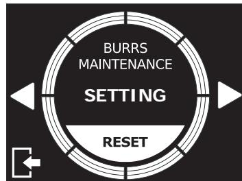
En appuyant **SETTING**, on accède au menu pour activer/désactiver l'alarme de l'entretien des meules et on peut choisir les dimensions et le type de meules.
