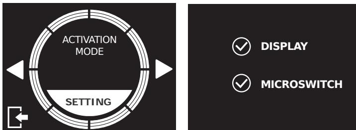
Después de pulsar la tecla **CONFIGURA**, puede seleccionar si desea activar la molienda pulsando la tecla de dosis en la pantalla (**B**, **L**, **C**, **H**) o activarla mediante el botón de activación de la molienda (**6**). También puede seleccionar ambos modos.
