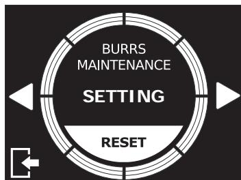
Pulsando la tecla **CONFIGURA**, se accede al menú para activar/desactivar la alarma del cambio fresas y a la configuración del tamaño y tipo de muelas.
