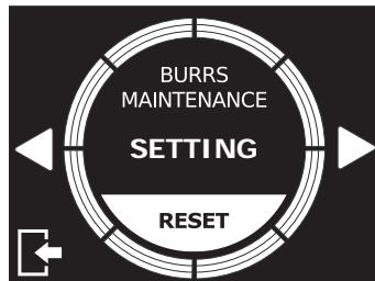
Premendo il tasto **SETTING**, si accede al menu per attivare/disattivare l'allarme di cambio macine e all'impostazione della dimensione e tipo delle macine.
